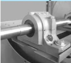
Für die Aufnahme von Messfühlern zur Stoßimpulsmessung kann eine Gewindebohrung M6 oder M8 im Stehlager- Gussgehäuse vorgesehen werden. (Der Messstutzen ist nicht Bestandteil des Lieferumfangs).
