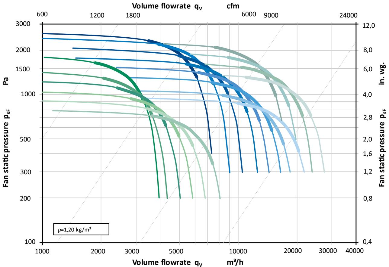
Das Diagramm zeigt im Überblick die Baugrößen 250 mm bis 710 mm mit bis zu 8 kW Motorleistung in der maximalen Drehzahl der jeweiligen Baugröße. Hervorgehoben sind die Bereiche mit den besten statischen Gesamt-Ventilatorwirkungsgraden (Betriebsbereich mit bestem Wirkungsgrad).
