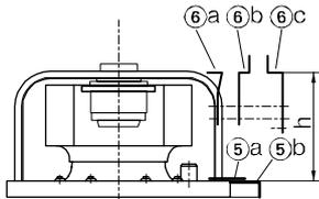
Tragplatte (5)b und Verbindungsplatte (5)a wie angezeigt montieren (Schrauben aus Beipack).
