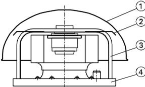
Kunststoff-Haube (1) entfernen. Nieten des Haubenbügels (2) abbohren und Bügel entfernen, das Ventilator-Modul (3) und der Grundrahmen (4) sind nun frei zugänglich.
