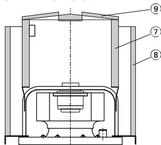
Innenkulis (7) aufsetzen und mit 2 Blechschrauben montieren.
