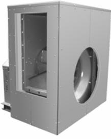
1. Rahmen R2 auf das unter den Ventilator vormontierte Bodenblech K9 stellen und verschrauben
