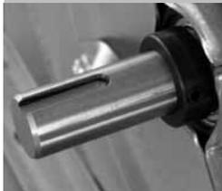
Gli alberi sono realizzati con barre di acciaio C40 accuratamente rettificare. Nella maggioranza degli alberi, l'esecuzione è continua, senza spallamento dell'albero. Gli alberi delle serie RDH K1 e K2, grandezza 1000, presentano le due estremità con diametro ridotto, in corrispondenza di cuscinetti e pulegge.
