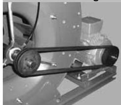
Le cinghie trapezoidali strette ad alte prestazioni, conformi alla norma DIN 7753, sono termostabili fino a +80 °C, resistenti agli oli minerali ed elettrostaticamente conduttive. Le pulegge sono realizzate in ghisa grigia di alta qualità e, a seconda del numero di gole, sono equilibrate staticamente (G 16) o dinamicamente (G 6.3). Il fissaggio all'albero motore o all'albero ventilatore avviene tramite bussole coniche.
