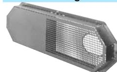
La protezione della cinghia di serie è realizzata in lamiera d'acciaio zincata ed è chiusa su tutti i lati (secondo DIN EN ISO 13857). È possibile staccare e togliere la parte anteriore a scopo di ispezione.
