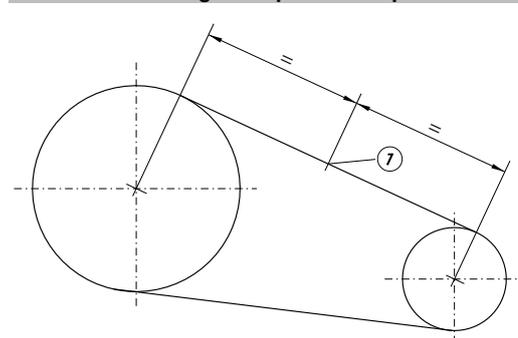
Un ulteriore metodo per la regolazione o il controllo della corretta tensione della cinghia consiste nel misurare la frequenza statica della cinghia di trasmissione. In questo caso, si batte sulla cinghia piana o trapezoidale ferma per causarne un moto oscillatorio proprio. Questa oscillazione viene misurata con uno strumento di misura elettronico (ad es. un trummeter). L'oscillazione in Hz va regolata sul valore indicato (documentazione / targhetta).
