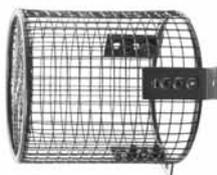
Protezione anticontatto dell'estremità libera dell'albero per ventilatori centrifughi a doppia aspirazione. Esecuzione secondo DIN EN ISO 13857, realizzazione in acciaio verniciato o zincato.
